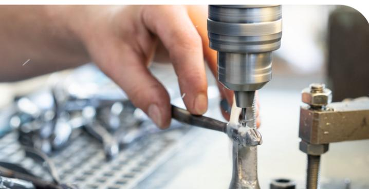
Der in Solingen geschmiedete Rohling durchläuft mehrere Aufbereitungsschritte in der Manufaktur, bis er in RUCK Qualität fertiggestellt wird. Rund um das Schmiedeteil müssen bis zu 0,3 mm Material abgetragen werden, um sicherzustellen, dass keine korrosionsunbeständigen Bestandteile auf der Oberfläche verbleiben. Alle Arbeitsschritte sind dabei streng aufeinander abgestimmt und müssen präzise ausgeführt werden, da sie aufeinander aufbauen. Daher gilt: Vorher schon an nachher denken.
